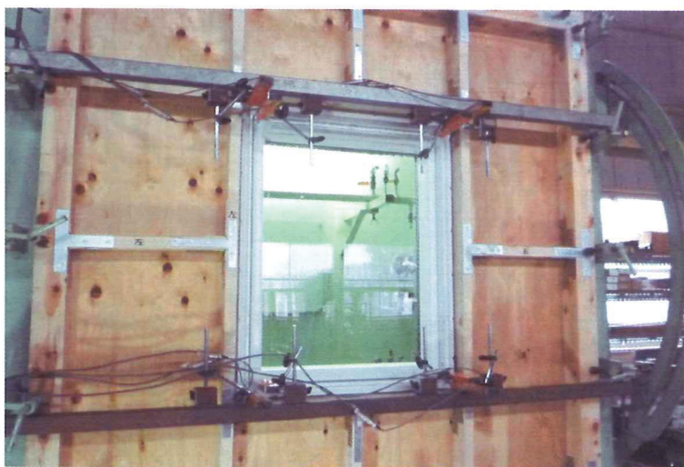
写真 4.3 耐風圧性 試験実施状況
